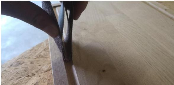
Das Schneidebrett schleife ich per Hand zunächst mit Schleifpapier mit 80 Körnung, dann 150 und später mit 240 Körnung. Beim Schleifen solltest du beachten, dass die Safrinne etwas intensiver geschliffen werden muss weil sich dort dunkle Flecken von der Oberfräse gebildet haben.
