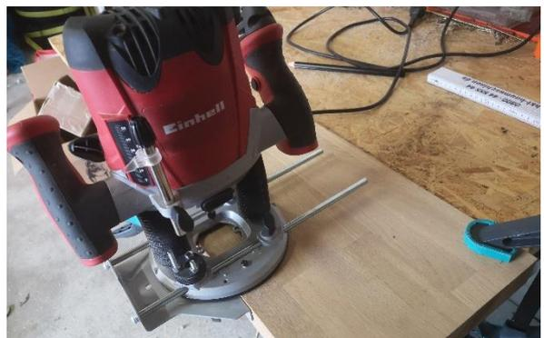
An dem Eckpunkt der Saftrinne fange ich an zu fräsen. Ist die Maschine angeschaltet, drücke ich die Oberfräse nach unten, bis diese den Anschlag erreicht. Nun kann ich den Feststellhebel umlegen und die Oberfräse bleibt in dieser Position. So kann ich die Oberfräse, ohne weiter runter zu drücken, ganz einfach mit dem Seitenanschlag an den Kanten des Schneidebretts entlangführen.
