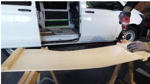
Auf der Rückseite der mittleren Platte befestigen wir die anderen beiden Leisten genauso und bringen an jede Leiste den jeweiligen Auszug an.
