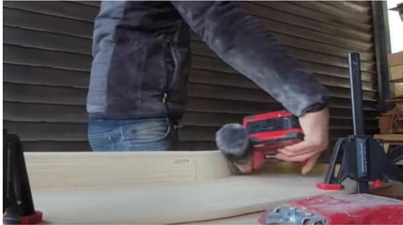
Am Ende muss die Schrankfront eben sein, denn darauf wird das Biegesperrholz geleimt, das die Schrankfront bilden soll.
