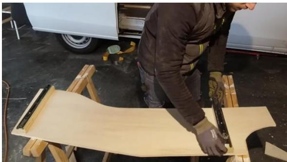
**Tipp:** Bei der Befestigung der Leisten ist die parallele Lage des Auszugs zum Boden wichtig. Deshalb muss die Lage der Leisten unbedingt vorher im Fahrzeug eingezeichnet werden.
