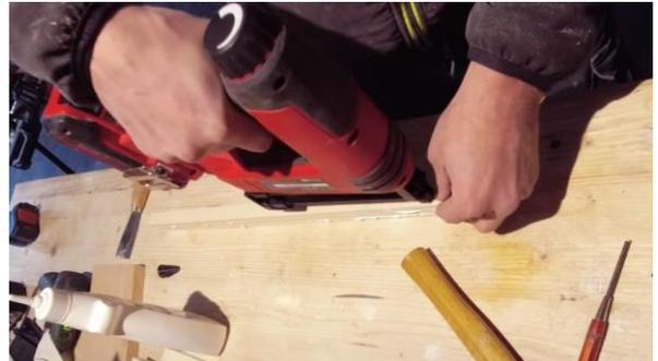
Sie sollen den Spalt zwischen der ausziehbaren Platte und der Schrankseitenwand fast vollständig verdecken. Damit der Schrank nicht hakt, haben wir 10 mm Platz zur Seitenwand gelassen. So haben diese zusammengeleimten Streifen auf der linken Seite eine Breite von 90 mm und auf der rechten Seite sind es 60 mm.
