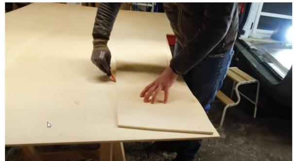
Jetzt haben wir drei identische Platten aus 10 mm Pappelsperrholz: zwei Seitenwände und die mittlere Platte. Sie müssen nur noch an die Kontur des Fahrzeugs angepasst werden.
