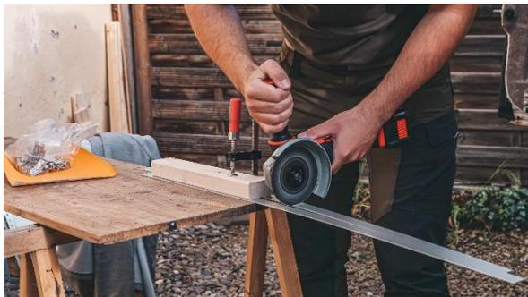
Dafür schneiden wir nun das Aluflachprofil mit dem Winkelschleifer zu. Wir haben hier jeweils die drei äußeren Bretter links und rechts mit einem Aluprofil und je drei Schrauben (4x16 Senkkopf) pro Brett verbunden.
