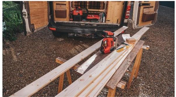
Das gesamte Holz wird dann mit 120er Schleifpapier geschliffen und die Kanten gebrochen.
