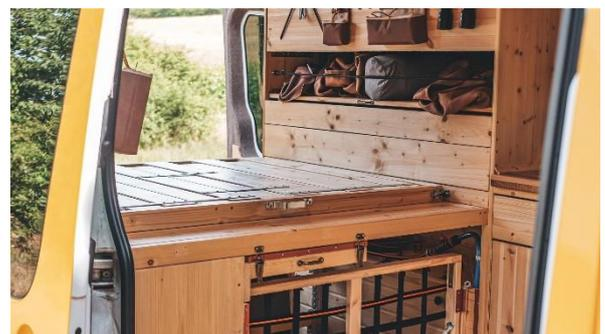
Diese können bei Bedarf zur Ladungssicherung in der Seitenkonstruktion im Van versenkt werden.
