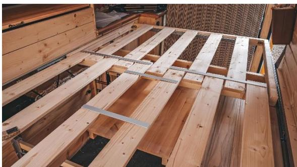
Anschließend haben wir die mittleren beiden Bretter des hinteren Lattenrosts mit zwei weiteren Aluprofilen verschraubt. So sieht die Konstruktion dann aus, wenn beide Teile ineinandergeschoben sind:
