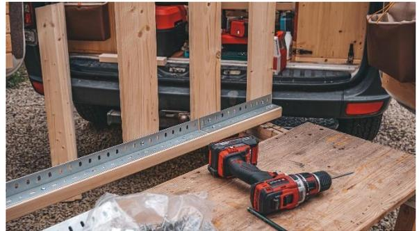
Danach machen wir alle 118 mm einen Strich, legen ein Brett an und schrauben es mit dem [Akku-Bohrschrauber](#) mit 5x16 Linsenkopfschrauben fest, solange bis alle Bretter gleichmäßig verteilt befestigt sind (siehe Bild oben).
