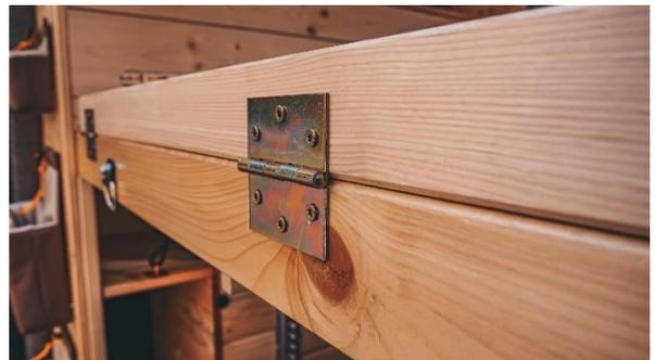
Dafür schraubt ihr die Scharniere mit je 50mm Abstand zur Außenkante des 950 mm langen Querbalkens (hinteres Teil) mit 5x30 Senkkopfschrauben bündig zur Grundkonstruktion an und schraubt sie danach dort ebenfalls fest.
