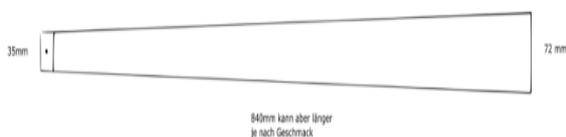
Nachdem du nun alle Teile angezeichnet hast, kannst du dir eine Stichsäge oder Bandsäge zur Hilfe nehmen und alle Bestandteile aussägen.
