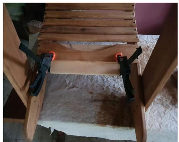
Die Armlehne fixierst du nun an dem vorderen Bein mit zwei Schrauben. Bitte darauf achten, dass die Aussparung hinten gut anliegt. Anschließend befestigst du diesem auch am hinteren Bein.
