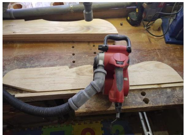
Danach kannst du die Sitzleisten aussägen und anschließend auch dort die Kanten abrunden und abschleifen. Dann nimmst du dir eine Oberfräse um damit alle Kanten zu bearbeiten und schön abzurunden. Du kannst auch hier gerne einen Fräser für größere Rundungen nehmen. Jetzt musst du mit einem Schleifklotz (mit feinem Schleifpapier) noch alles nacharbeiten.
