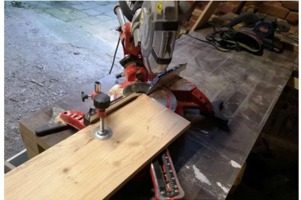
Zuerst zeichnet Ihr euch die verschiedenen Längen auf den Brettern an und schneidet diese mit dem entsprechenden Winkel zu. Die Maße kannst du dem Plan entnehmen. Beim Schneiden des Brettes solltest du darauf achten, dieses immer einzuspannen, und auf die PSA achten. Beim Arbeiten mit der Kappsäge trage ich zum Beispiel immer eine Schutzbrille, einen Mundschutz und lege Ohrenschützer an.
