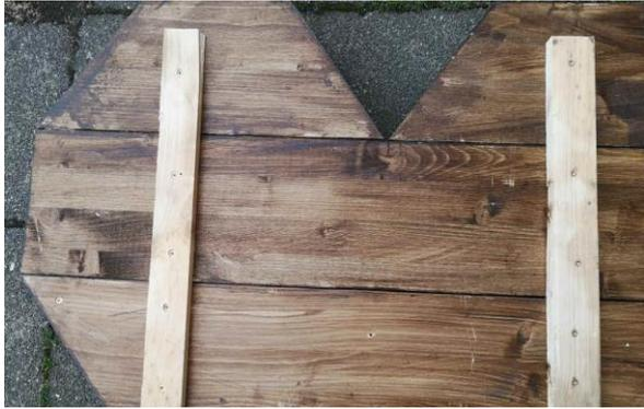
Anschließend lasiere ich das ganze Projekt noch einmal und schneide mir dann mit der Kreissäge zwei Bretter mit jeweils 25 cm Länge und 5 cm Breite für die Rückseite zu. Habt ihr keine Kreissäge zur Hand, könnt ihr euch auch ein Brett oder eine Leiste mit dieser Breite kaufen oder diese zuschneiden lassen.
