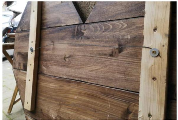
Nun nehme ich mir einen beliebigen Draht und schneide diesen auf den Abstand der zwei hinteren senkrechten Leisten zu. Mit einer Schraube inklusive Unterlegscheibe befestige ich den Draht. So habe ich eine gute Möglichkeit, das Brett später aufzuhängen.
