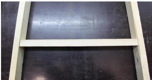
Jetzt kannst du die einzelnen Sprossen nach und nach einpassen. Dabei zeichnest du die oberen Abstände auf der ungekürzten Sprosse an und sägst sie mit der Kapp- Gehrungssäge auf die richtige Länge.
