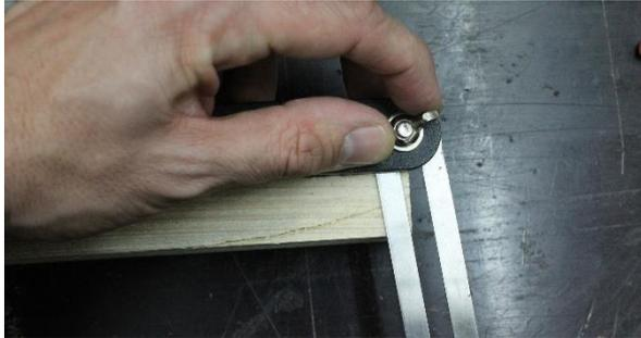
Mit der eingestellten Winkelschmiege richtest du anschließend die Kapp-Gehrungssäge aus beziehungsweise stellst den richtigen Winkel ein.
