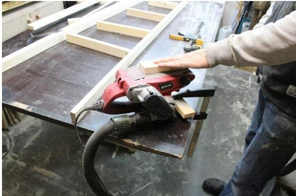
Für die kleineren Sprossen kann man den Bandschleifer auf der Arbeitsplatte fixieren und die kleinen Teile einzeln per Hand über den Bandschleifer führen. Hier ist allerdings Vorsicht geboten! Schleift man die Latten gründlich ab, kann es sein, dass die Markierungen nicht mehr zu sehen sind. Dann musst du die Abstände der Sprossen erneut ausmessen (s.o.).
