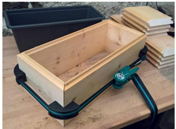
Dies ist notwendig, da wir durch unsere Gehrungsschnitte die Schrauben recht nah am Brettrand setzen müssen und die Gefahr, dass etwas absplittert sonst zu hoch ist.
