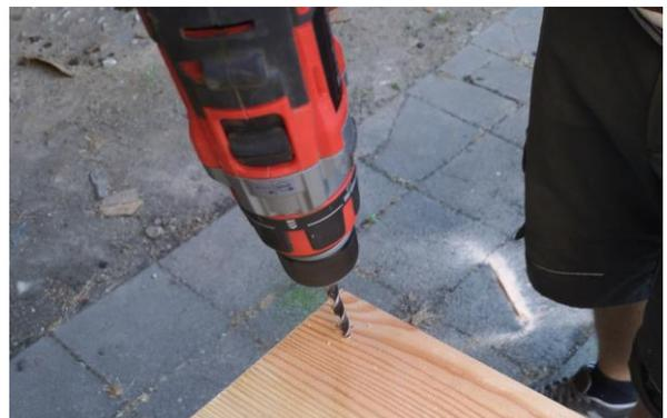
Dort bohrt ihr mit dem Akkuschauber und einen 12 mm Holzbohrer Löcher in beide Platten. Diese werden später für die Aufhängung benutzt.
