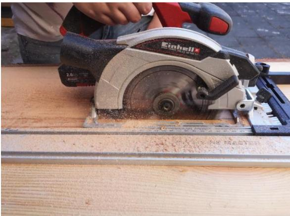
Für einen sauberen, geraden Schnitt verwendet ihr am besten eine Führungsschiene, spannt die Holzplatte vorher ein und tragt die PSA ein.
