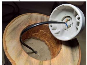
Nachdem die einzelnen Scheiben verleimt wurden, kann auch der Deckel der Lampe mit dem restlichen Körper verklebt werden. Durch die voraussichtlich lange Lebensdauer der LED Technik muss man sich um einen Leuchtmitteltausch keine Gedanken machen!
