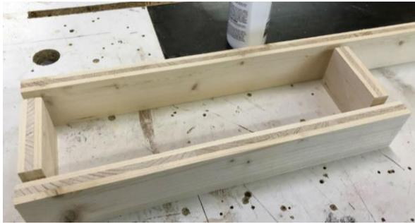
Im nächsten Schritt leimen wir nun alle 6 cm breiten Holzstücke (790\*60 mm, 400\*60 mm, 90\*60 mm) auf Stoß zusammen. Die Konstruktion wird zusätzlich mit Zwingen fixiert und dann trocknen gelassen.
