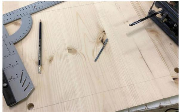
Für den Ausschnitt kann man eine Oberfräse verwenden. Alternativ könnt ihr die Ecken des aufgezeichneten Rechtecks mit einem Forstnerbohrer ausbohren und anschließend die Seiten mit einer Stichsäge aussägen.
