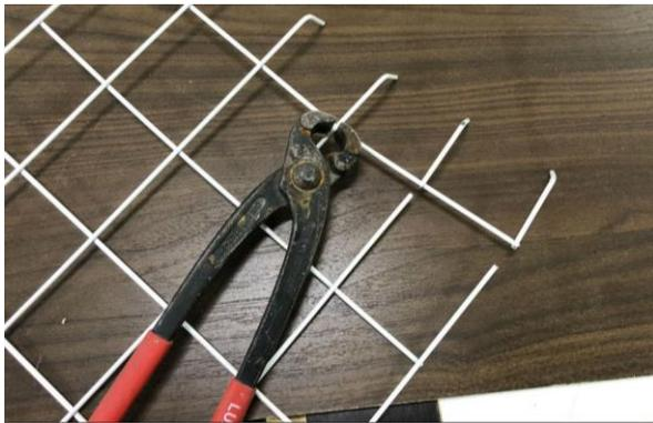
Hierfür messen wir nun 30 mm, gemessen vom äußeren Rand des Überstands nach innen ab und markieren uns diese Stelle. Anschließend klemmen wir das überstehende 30 mm lange Gitter mithilfe eines Stück Restholzes an eine Tischkante fest und biegen diesen Rand langsam über die Kante.
