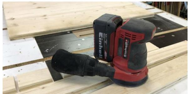
Die große Grundplatte (800\*600 mm) lassen wir im folgenden Schritt mal außen vor. Alle anderen Holzstücke schleifen wir richtig glatt. Ich habe alles von Körnung 100 bis Körnung 320 mithilfe meines Exzentrerschleifers abgeschliffen.
