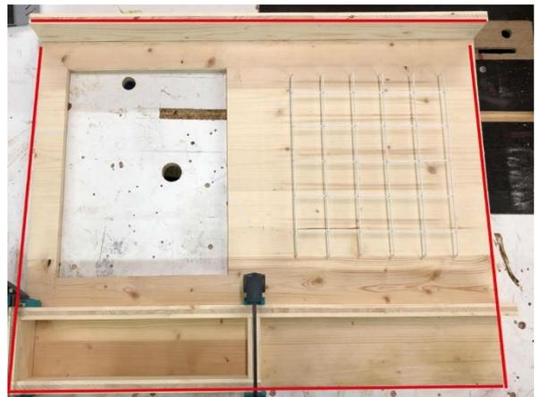
Wenn alle Teile ihren Platz gefunden haben, zeichnen wird die Umriss der Gegenstände auf der Platte vor und machen schon jetzt alle Bohrungen für die spätere Endmontage. Für das Gitter bohren wir für jedes Drahtende ein kleines 2 mm tiefes Loch ins Holz. Die Bohrungen für die Haken habe ich von der Rückseite noch mit einem Forstnerbohrer gesenkt, um die Mutter verstecken zu können. Zudem könnt ihr auf der Rückseite alle Bohrungen mit einem Senker senken.
