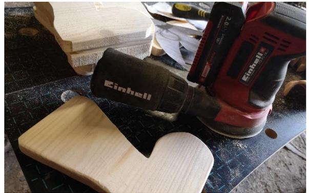
Ist der Schuh zugeschnitten, schleife ich die Flächen und Kanten gründlich mit einem Akku-Exzentrerschleifer ab. Beim Schleifpapier arbeite ich mich langsam von einer 120er Körnung bis zu einer 240er Körnung vor.
