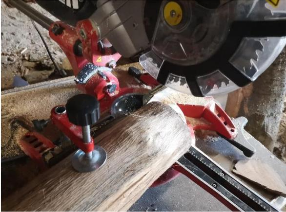
Mit der Kappsäge werden beide Enden des Baumstamms abgesägt, wodurch glatte Kanten entstehen. Hierbei kann man dem Projekt auch die gewünschte Länge verpassen.
