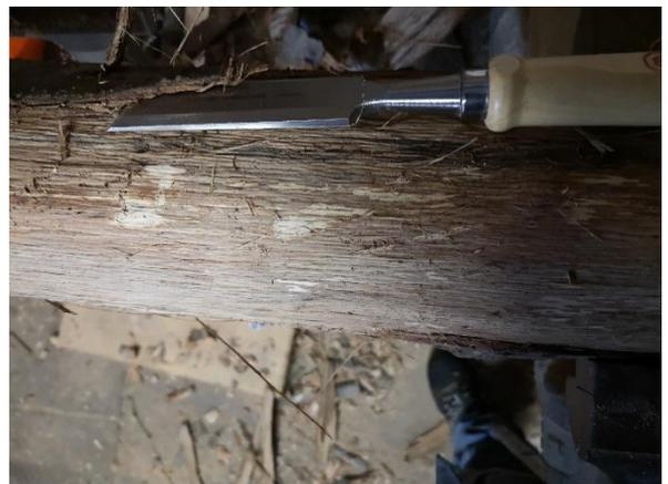
Zu Beginn dieses Projekts wird die Rinde vom Baumstamm mithilfe eines Stecheisens und einem Hammer entfernt. Um diese Arbeit zu erleichtern, ist es empfehlenswert, den Stamm mit Schraubzwingen auf der Werkbank
