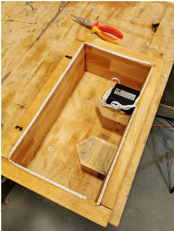
Am LED-Streifen und am Batteriefach befestigen wir jeweils einen Streifen doppelseitiges Klebeband. So können wir dann beide fest an unserem Bilderrahmen anbringen.
