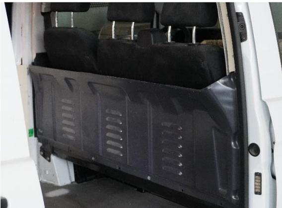
Wir bauen die Trennwand aus und schneiden sie in einer Höhe von 735 mm mit dem [Winkelschleifer](#) ab. Die Sägekante wird zudem mit einer Metallfeile entgratet und mit einer Rostschutzgrundierung behandelt. Danach wird die Trennwand wieder eingebaut.
