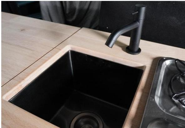
Damit der Ausbau am Ende nicht so schwer wird, verwenden wir für die rechte Küchenarbeitsplatte ein dünnes Leimholz (18 mm). Um die Optik einer dicken Arbeitsplatte zu bekommen, sägen wir einen 15 mm breiten Streifen aus Buchenholz zurecht und leimen diesen dann von unten an die vordere Kante der Arbeitsplatte. An die rechte untere Kante der Arbeitsplatte leimen wir einen 20 mm dicken Buchenholzstreifen.
