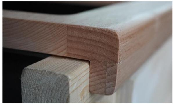
Nach dem der Leim getrocknet ist, schleifen wir die Vorderkante der Küchenarbeitsplatte mit einem Bandschleifer eben. Mit der [Oberfräse](#) fräsen wir dann eine schöne Rundung in das Holz. Die Sägekanten von der Öffnung der Spüle fräsen wir ebenfalls rund.
