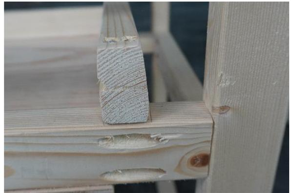
Auf jede Verbindungsstelle tragen wir etwas Leim auf und schrauben die Balken mit einem [Akku-Bohrschrauber](#) zusammen.
