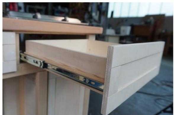
Damit wir die Auszüge der Schublade am Küchengerüst befestigen können, muss die Balkenkonstruktion erweitert werden. Dafür nehmen wir wieder 26 x 45 Balken und bauen daraus eine Konstruktion, bei der zwei Balken genau dort sind, wo die Auszüge befestigt werden müssen.
