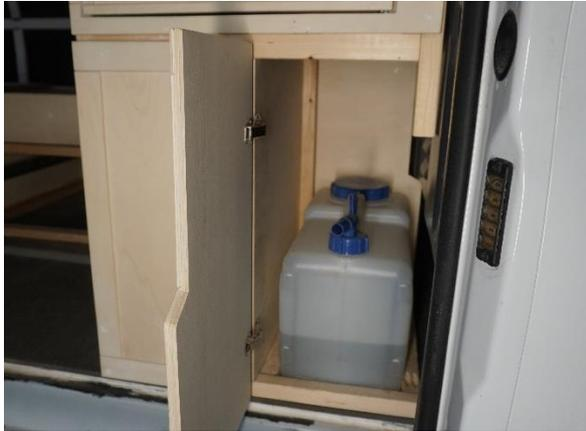
Die Klappe wird anschließend mit Scharnieren am Balken befestigt und durch Magnete geschlossen gehalten.
