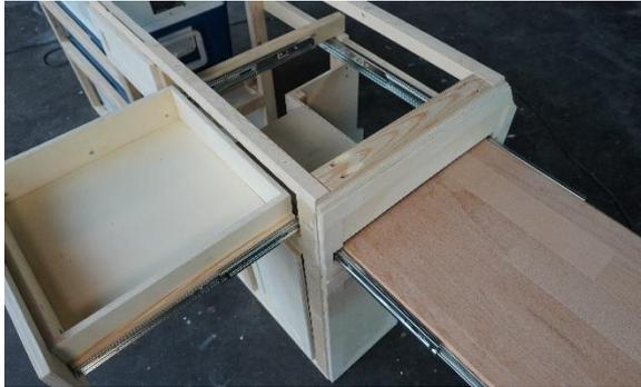
An diesem Balken befestigen wir dann die Außenschienen der Auszüge und können anschließend die Schublade einsetzen. Die Schublade ist absichtlich nicht so tief, da bei uns hinter der Schublade später die Gasleitungen zum Gaskocher gelegt werden.
