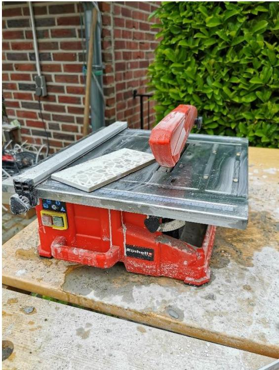
Dazu könnt ihr unterschiedliche Geräte verwenden, zum Beispiel einen Winkelschleifer, einen Handfliesenschneider oder eine Fliesenschneidmaschine. Ich benutze die Fliesenschneidmaschine TC-TC 800. Die hat im Gegensatz zu den Winkelschleifern einen Wasserbehälter zur Kühlung des Sägeblattes, was den Zuschnitt der Fliesen sehr erleichtert.
