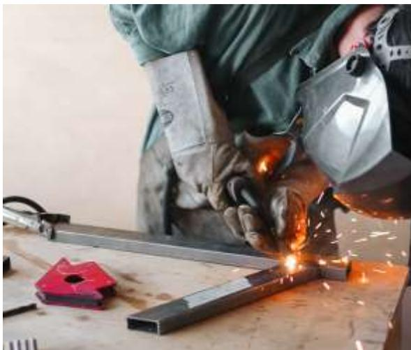
Die Schweißnähte können, falls sie nicht gleich zufriedenstellend aussehen, mit dem Akku-Winkelschleifer glattgeschliffen werden. Dies sorgt für ein schöneres Endergebnis.
