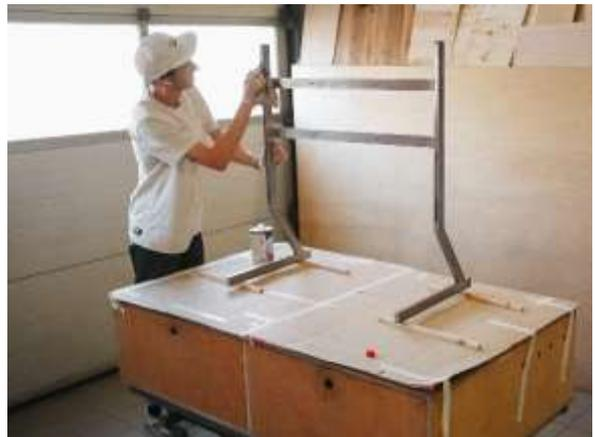
Nachdem die Grundierung getrocknet ist, könnt ihr auch diese nochmal feinschleifen und das Material mit Verdünnung reinigen, bevor der Lack auf den Ständer kommt.
