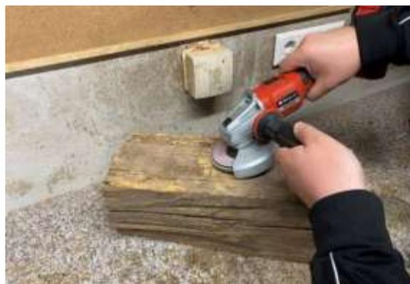
Im nächsten Schritt nehme ich den Akku-Exzentrerschleifer und schleife den ganzen Balken nochmal mit 120er und 240er Schleifscheiben.
