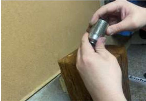
Die Fassung befestige ich mit Alleskleber. Den trage ich auf dem unteren Teil der Fassung auf und setze die Fassung in das Loch. Bitte drauf achten, dass die Fassung auch gerade ist.
