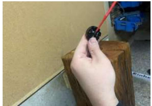
Nach dem Anschließen muss die Fassung in das Fassungsgehäuse gesetzt und zusammengeschraubt werden.
