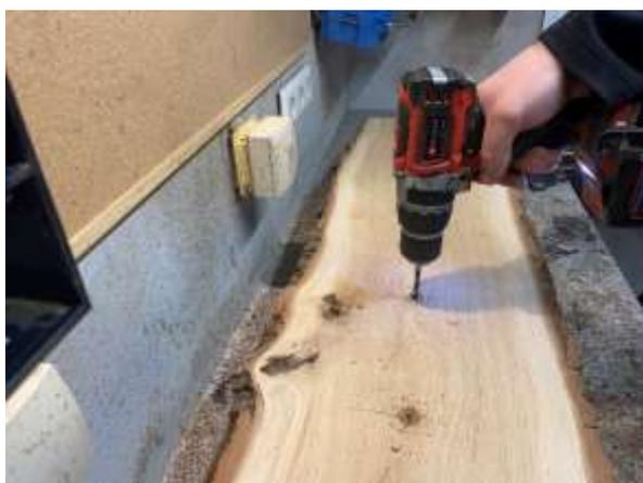
Anschließend setze ich mit dem 68 mm Forstnerbohrer an und bohre komplett durch das Brett durch.
