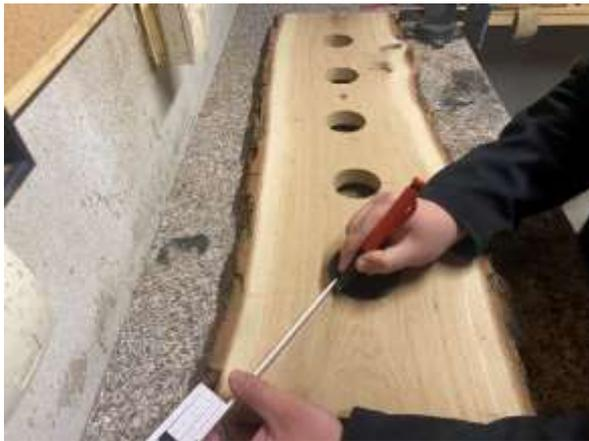
Mit einem 4 mm Bohrer bohre ich die Löcher. Hierdurch kann ich mit einem Tieflochmarker später die Löcher an der Decke markieren.
