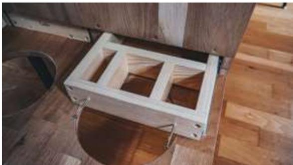
Nun kommt das Klavierband an seinen Platz und verbindet den Deckel mit dem Korpus. Hier kann auch der Möbelknauf mit einem 4 mm Bohrer eingebohrt und festgeschraubt werden.
