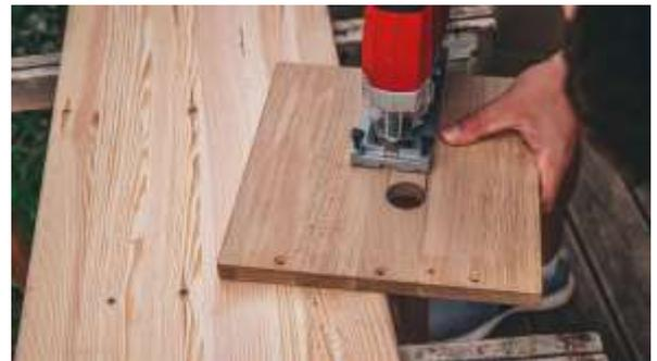
Die Löcher bohren wir im Abstand von 110 mm von Außenkante zu Außenkante. Diese werden mit der Stichsäge verbunden und geschliffen. Es ergibt sich ein längliches, ovales Loch, welches sich mittig einer Hälfte befindet. Je nach Auszugart muss der Futtergeber neu angefertigt und das Langloch angepasst werden.
