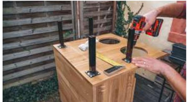
Um die Schubkästen voneinander zu trennen, verschrauben wir die vorbereiteten Teiler mittig der Bodenplatte im Korpus. Darauf wird später die Futtergeberplatte Platz finden und die Schräge im Korpus selbst. Zuvor müssen jedoch die Auszüge montiert und bündig mit der Kante der Seiten ausgerichtet werden. Wir benutzen Reststücke des Rahmenholzes, um so überall den gleichen Abstand einzuhalten.
