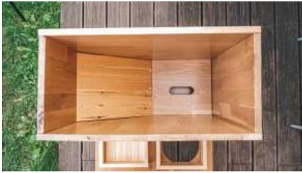
Die Schubkasten-Teiler werden im letzten Schritt ebenfalls im rechten Schubkasten festgeschraubt. Hier wird der Abstand der Teiler dazu genutzt, die Futtermenge für den Hund zu regulieren, welche durch den Futtergeber in den Schubkasten fällt. Bei uns beträgt der Abstand 85 mm.
