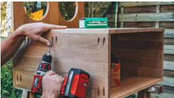
Die Seitenteile werden mit 4 x 30 Senkkopfschrauben mit der Rückwand, der Bodenplatte und der Front verschraubt.
