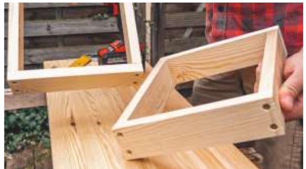
Beim Verschrauben verwenden wir 4,5 x 50 Schrauben mit Senkkopf und leimen die stumpfe Verbindung.
