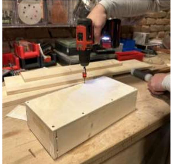
Zudem verschließt ihr die eben gebohrten 8 mm Löcher in den Seitenwänden mit Holzstopfen. Dafür nehmt ihr einen 8 mm dicken Rundstab, gebt etwas Leim an die Spitze, steckt den Stab in das Loch und schneidet ihn mit der Handsäge bündig ab.
