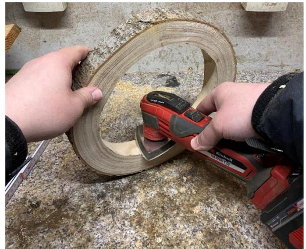
Die Lärchenbohle wird mit einem Akku-Exzentrerschleifer geschliffen, ebenfalls mit Schleifpapier der Körnungen 80,120 und 240.
