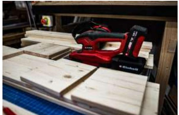
Auch das Schleifen von Flächen ist ein wichtiger Schritt bei der Vorbereitung von Holzmaterialien für die weitere Bearbeitung oder Fertigstellung. Für schöne glatte Oberflächen nehme ich den Akku-Exzentrerschleifer TE-RS 18 zur Hand und schleife die Holzzuschnitte damit ab.
