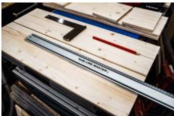
**Tip:** Bei der Messung solltet ihr immer die gleiche Kante als Referenz verwenden, um einen möglichen Messfehler so weit wie möglich zu minimieren. So stellt ihr sicher, dass die Regalböden genau auf die vorgesehenen Positionen passen.
