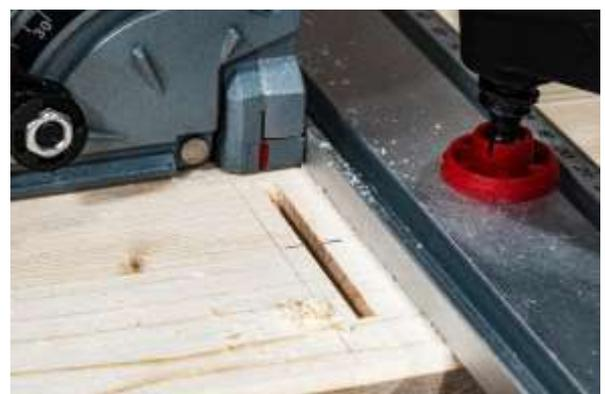
Dann fülle ich Leim in die Schlitze und setze die Flachdübel ein. Jetzt sind die Regalböden für die Montage vorbereitet.
