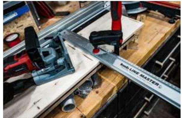
Den Mittelpunkt für die 10er Flachdübel setze ich immer 50 mm vom Rand entfernt. Dafür verwende ich ein Lineal mit einem festen Anschlag.
