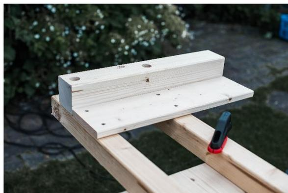
Direkt daneben kommt noch zur Verstärkung jeweils ein Brett (2-mal 18 x 120 x 460 mm). Das bringt etwas mehr Stabilität in die gesamte Konstruktion.
