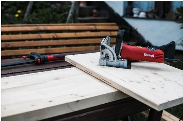
Nachdem wir nun zwei Seitenstücke für den Tresen haben, benötigen wir noch das Mittelstück, welches die beiden Seitenstücke verbindet. Unter dem Mittelstück werden später zwei Holzkisten positioniert, deshalb schneiden wir die andere Leimholzplatte auf das gleiche Maß zu, wie die zwei Kisten an der langen Seite. Also in diesem Fall  $460 \text{ mm Kistenlänge} \times 2 = 920 \text{ mm}$ .
