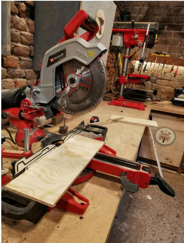
Hierfür müssen 4 Seitenteile aus der 15 mm Multiplexplatte geschnitten werden. Damit der Tisch später problemlos auf den Getränkekasten passt, muss das fertige Gerüst ein wenig größer sein als der Bierkasten selbst – also sauber Maß nehmen und anzeichnen! In unserem Fall betragen die Maße des Getränkekastens ca. 42 x 32 cm.
