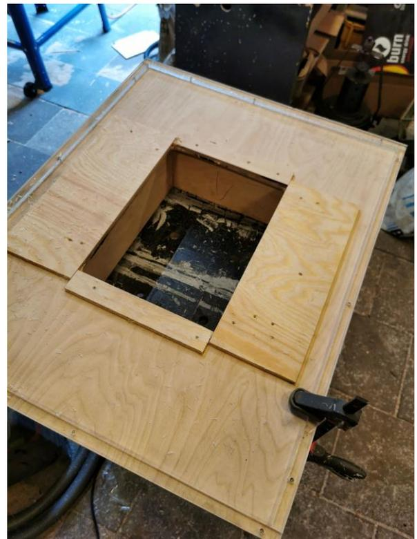
Um die obere Tischplatte (die mit der kleineren Öffnung) nun auf der unteren Tischplatte fixieren zu können, benötigen wir zunächst noch 8 weitere Multiplex-Teilstücke. 4 davon werden um die Öffnung
