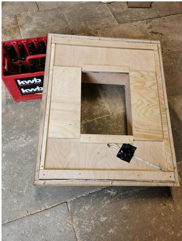
Der Treiber der Beleuchtung wird an der Seitenwand des Rahmens befestigt. Als nächstes kann alles ans Stromnetz angeschlossen und getestet werden. Für eine schönere Optik wird der Treiber noch mit Multiplex verkleidet.
