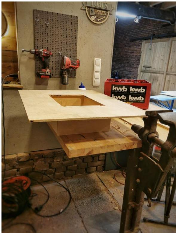
Im nächsten Schritt kann die untere Tischplatte mit der größeren Öffnung am Unterbau befestigt werden. Dafür benutzen wir Holzschrauben, die mit passenden Bits von oben in den Rahmen geschraubt werden.
