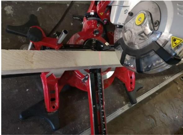
Nun schneidest du daraus 4 Stücke jeweils auf 120 cm mit der Kappsäge zu. Damit die Leiter später einen sicheren Stand bekommt, schneidest du die Stücke dazu mit einem Winkel von 15 Grad zu.
