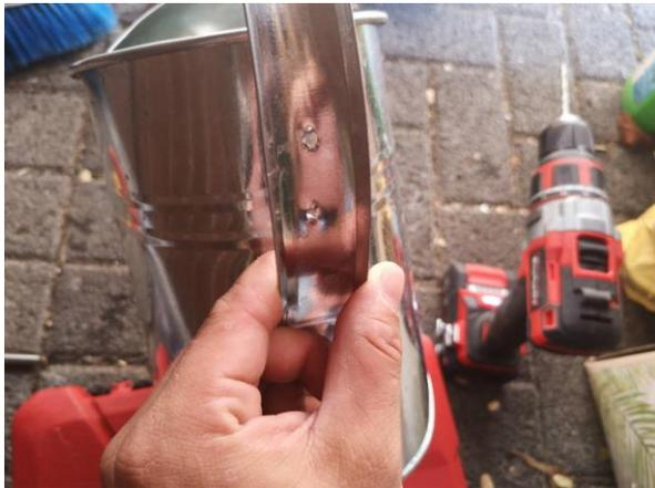
In die Gießkanne bohrst du nun mit einem 5 mm Eisenbohrer zwei Löcher in den Henkel. Danach befestigst du die Leiter mit einer 5x 30 mm Schraube.
