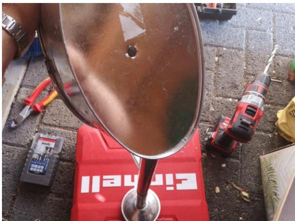
Anschließend bohrst du auf der Unterseite der Gießkanne ein Loch, durch welches der Schlauch gesteckt wird. Die Größe richtest du hierbei nach Dicke des Schlauches aus.
