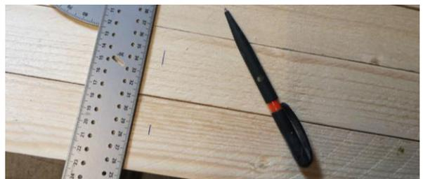
An diesen Stellen sollen anschließend mit einem 4er-Bohrer die Holzlatten vorgebohrt werden.
