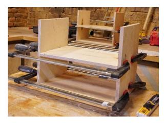
Nachdem der Korpus fertig getrocknet ist, können die Zwingen abgenommen werden. Jetzt schleife ich diesen nochmal grob mit dem Exzenterschleifer und Schleifpapier mit einer 80er Körnung ab.
