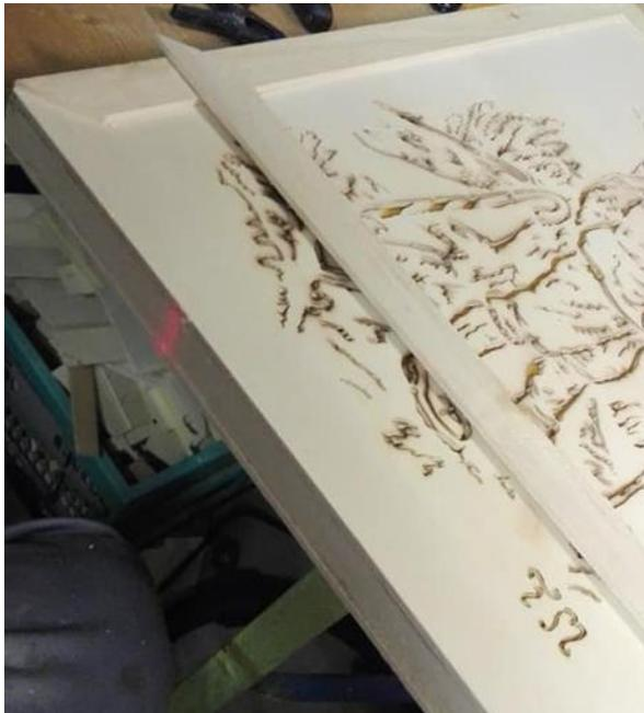
Um das Bild auf der Vorderseite abzurunden, bringe ich auch dort noch einen Rahmen an. Bevor die Rahmenleisten mit Holzleim befestigt werden, werden diese zuerst auf Gehrung zugesägt und an die Rahmenleisten angepasst.
