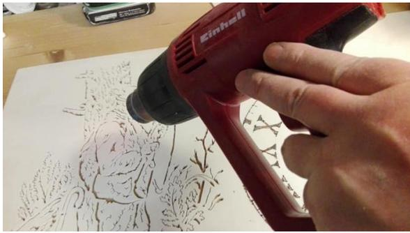
Mit einem [Heißluftgebläse](#) brenne ich die Sägestellen nach und hebe somit die Sägekanten hervor. Nach dem Brennen, sieht man die Sägestellen jetzt schon besser.
