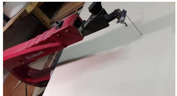
Damit man später auf das Uhrwerk und den Schalter der Lichterkette zugreifen kann, säge ich entsprechende Aussparungen aus der Rückwand. Das Zusägen der Rückwand und Ausarbeiten des Ausschnittes für das Uhrwerk erfolgt ebenfalls mit der [Dekupiersäge](#).
