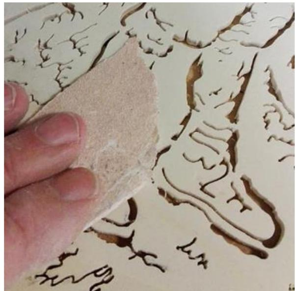
Nun wird das komplette Bild mit [Schleifpapier](#) feingeschliffen und somit von der Zeichnung noch zu sehende Konturen und auch Grade und Späne vom Sägen entfernt.
