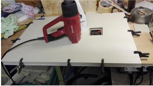
Mit Hilfe der Leimklammern werden die Rückwand und die Seitenleisten zusammen geklemmt, bis der Holzleim abgetrocknet ist.
