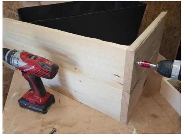
Dieses dient dazu, dass der Mörtelkasten nicht durchfällt und noch besser stabilisiert wird. Wir messen die Innenkante und sägen das Querbrett zu.
